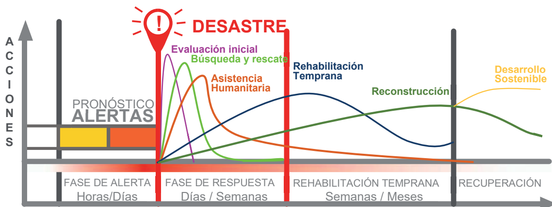
Figura 19. Esquema gráfico de tiempo y duración de las fases operativas en la respuesta
